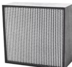
高效过滤器 (HEPA)：0.3um颗粒过滤效率大于99.99%
