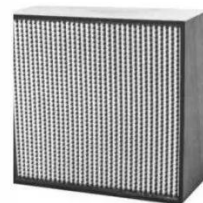
中效过滤器：1um颗粒过滤效率在20~70%
