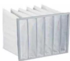
初效过滤器：5um颗粒过滤效率在20~80%
