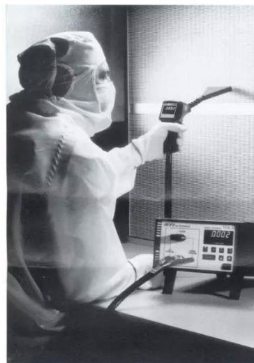
高效过滤器光度计 扫描方法示意图
