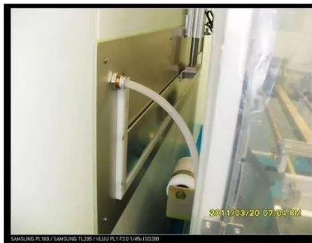
无菌区与非无菌区传送带传送——正压气流保护并有密封挡板
