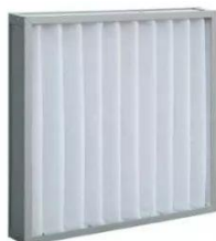
初效过滤器：5um颗粒过滤效率在20~80%
